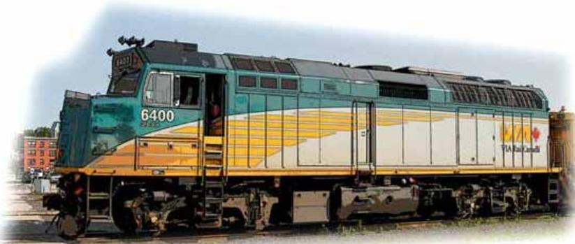
Locomotive de type F40PH-3, normalement utilisée en Gaspésie pour la traction des voitures du train *Le Chaleur*
